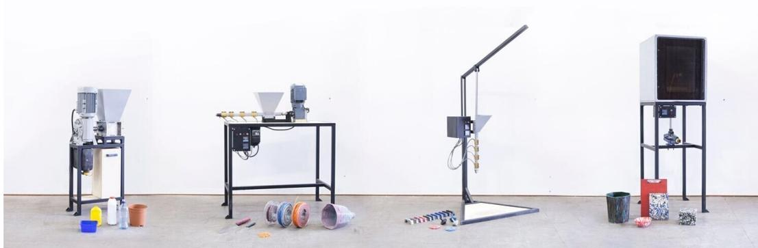
Figura 1: Macchine per il riciclo della plastica open source progettate da *Precious Plastic* (2013). Design Academy di Eindhoven.
